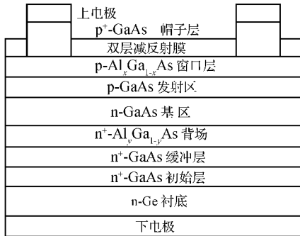
图 1 GaAs/Ge 太阳能电池结构示意图
