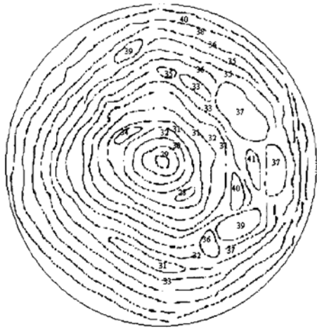
图9 四探针仪测得的硅片电阻率等值线分布图
