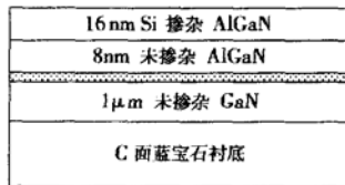
图 1 AlGaIn/GaN 结构的截面图
