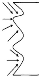
图3 侧壁起伏的突出和凹下部分的轰击粒子和反应离子来源示意图
