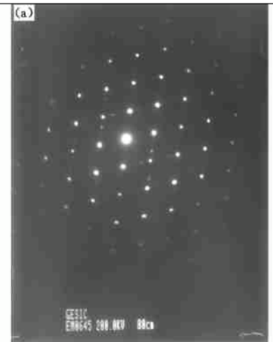
图 5(a) 3# 样品外延层的衍射斑点图
