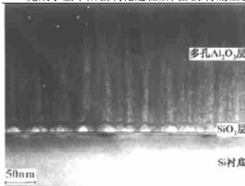
图4 硅基多孔氧化铝复合结构 横断面 TEM 照片
