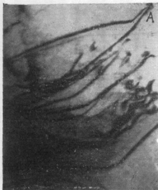
图 1 平面样品位错形貌象  $\times 120000$
