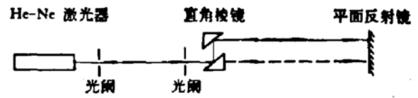
图 2 调节两块直角棱镜反射面平行的光路图
