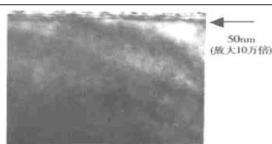
图 2 TEM 观测 S 型布抛光亚损伤层
